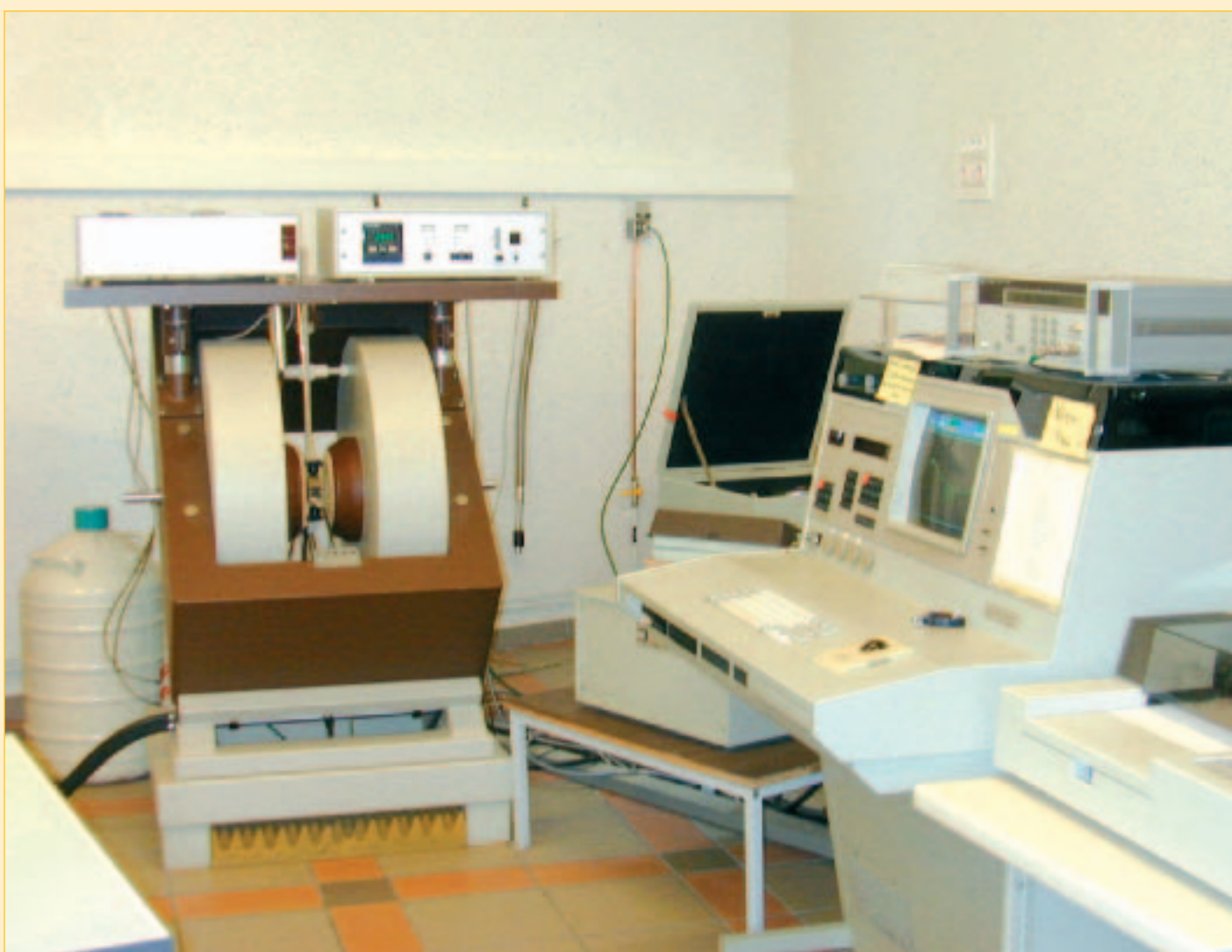
Mesure de résonance paramagnétique électronique (RPE). – Crédit photo : CEA
